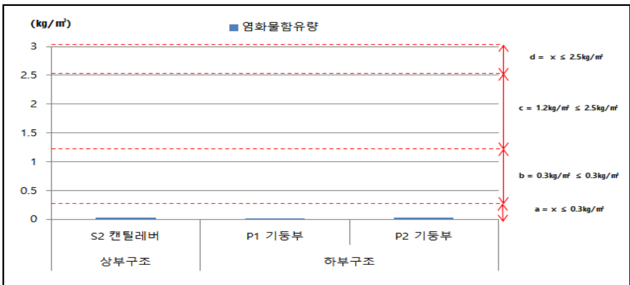
【그림 3.16】 염화물시험 측정결과
